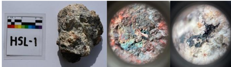
Gambar 12. Batu yang ter-oksidasi pada lokasi-1 dengan mineral magnetit ( \text{Fe}_3\text{O}_4 ) atau hematit ( \text{Fe}_2\text{O}_3 ) dan oksida tembaga, di Kecamatan Lantung, Kabupaten Sumbawa. Data: diambil oleh penulis
