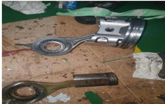
**Gambar 17. Penggantian piston kompresor yang baru**
