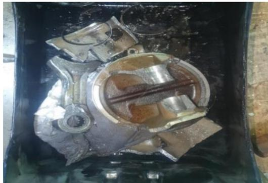
**Gambar 15. Kerusakan piston pada kompresor**
