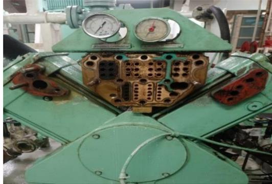
**Gambar 16. Kotornya tubenest assembly pada kompresor**
