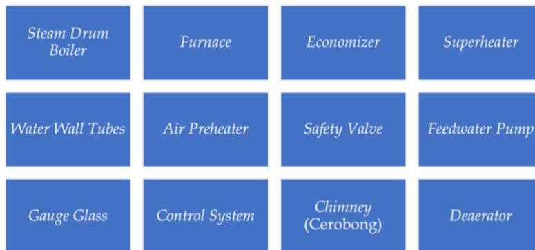
Gambar. 2 Komponen boiler
