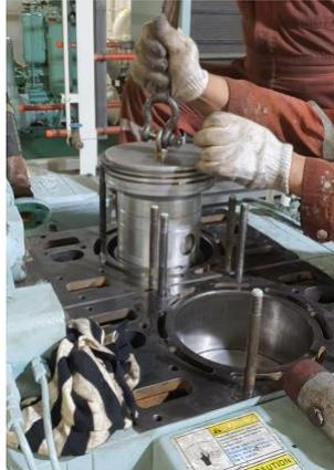
Gambar 9 proses pemasangan piston ke dalam ruang silinder mesin
