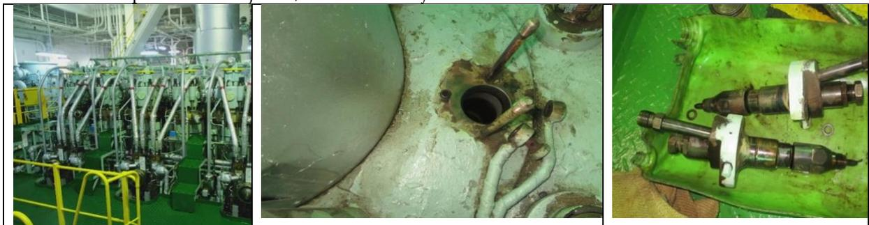
Gambar. 7 Kondisi pengecekan gas buang, pencabutan *injector*, kondisi *injector* setelah dicabut.
