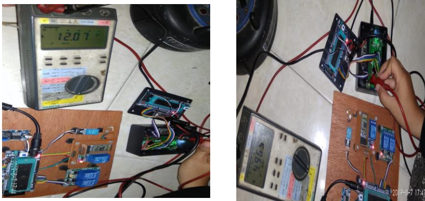
Gambar 1. Pengukuran Tegangan Input dan Pengukuran Regulator
