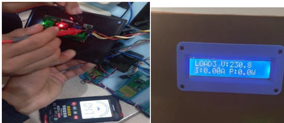
Gambar 7. Pengujian Liquid Crystal Display
