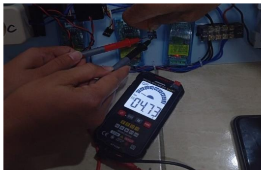
Gambar 3. Pengujian Sensor PZEM-004T
