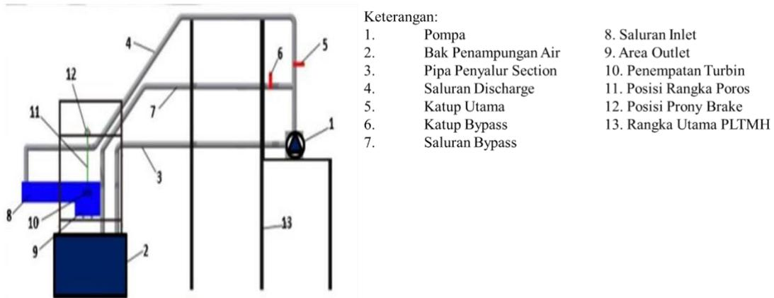
Gambar 1 Setup eksperimen
