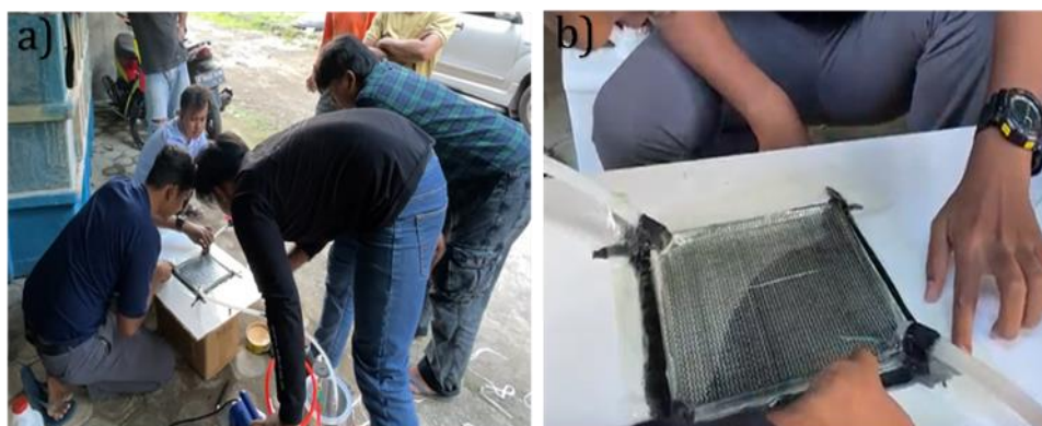
Gambar 2. Proses pembuatan komposit fiberglass menggunakan VARI: (a) setting cetakan agar udara tidak bisa masuk dan (b) proses penarikan resin ke cetakan
