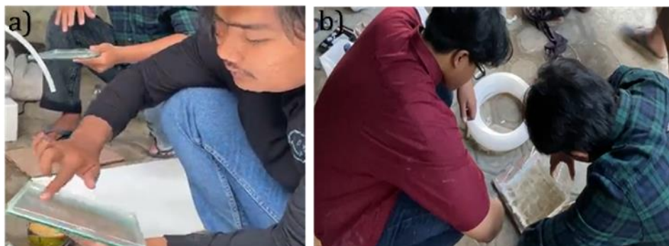
Gambar 1. Proses pembuatan komposit fiberglass menggunakan casting: (a) pengolesan release mould ke cetakan dan (b) proses penuangan resin polyester ke cetakan
